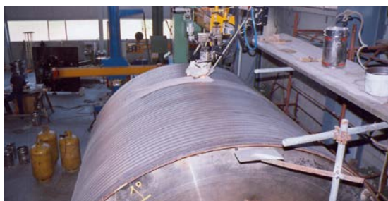
Paper Rolls (Alloy 14Cr2Ni1Mo) Soudotape 430 + Record EST 452
