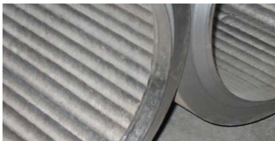
Pipes (Nickel alloy 825) Soudotape 825 + Record EST 236
